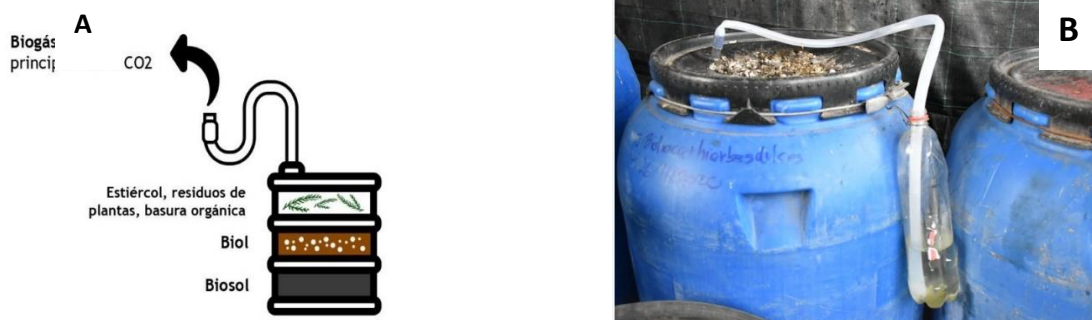
Figura 8: Esquema de un diseño básico de un equipo de fermentación líquida en la finca (A). Una imagen de un recipiente de fermentación en funcionamiento en los Andes (B).
